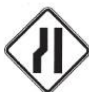
A-21b Estreitamento de pista à esquerda
