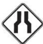
A-21a Estreitamento de pista ao centro
