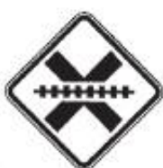
A-39 Passagem de nível sem barreira
