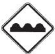
A-17 Pista irregular
